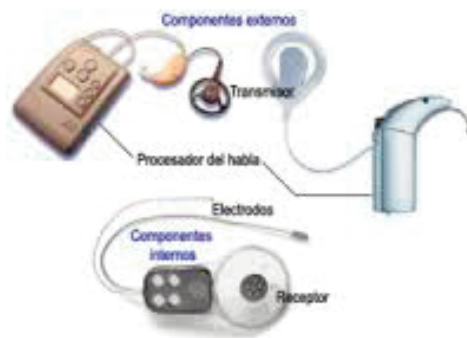
Figura 16. Principales componentes del implante coclear.
